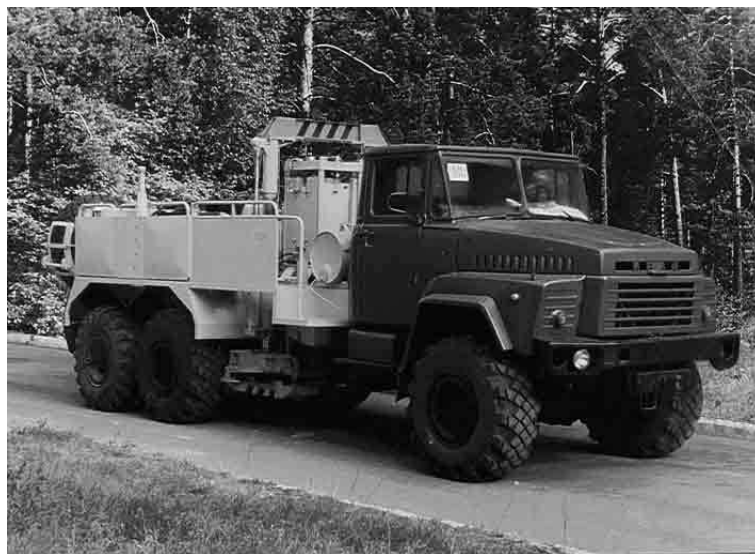
Рис. 10 Самоходная вибрационная установка возбуждения сейсмических сигналов СВ – 10/180
